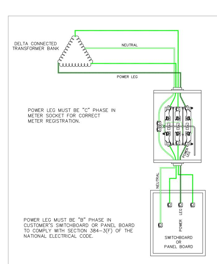
POWER LEG CONNECTION ON 3 — PHASE, 4 — WIRE DELTA CONNECTED SYSTEMS
